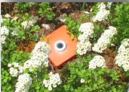
Des bornes fixes permettront de refaire le suivi exactement aux mêmes endroits dans quelques années
